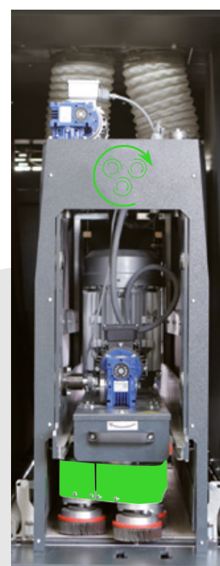
Gruppo spazzole tangenziali / sistema planetario Tangential brushes unit / planetary system Unidad de cepillos tangencial / sistema planetario
