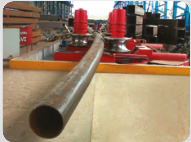
MCP PIPE 610 x 17,5 Ø15.000
